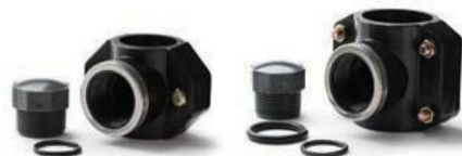
BL120-550/ 563/ 575 Suporte da sonda para tubos com 50/ 63/ 75 mm de diâmetro, rosca de 1 1/4"
