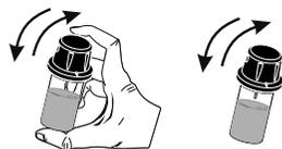
De modo a evitar o derrame do reagente e obter medições mais precisas, primeiro feche a cuvete com a tampa plástica HDPE fornecida e depois com a tampa exterior preta.
