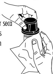
Agitar a cuvete pode gerar bolhas na amostra, provocando leituras mais elevadas. Para obter resultados precisos, remove tais bolhas agitando circularmente ou batendo cuidadosamente na cuvete.
