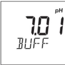
Altere a configuração através da tecla **SET**. Prima
