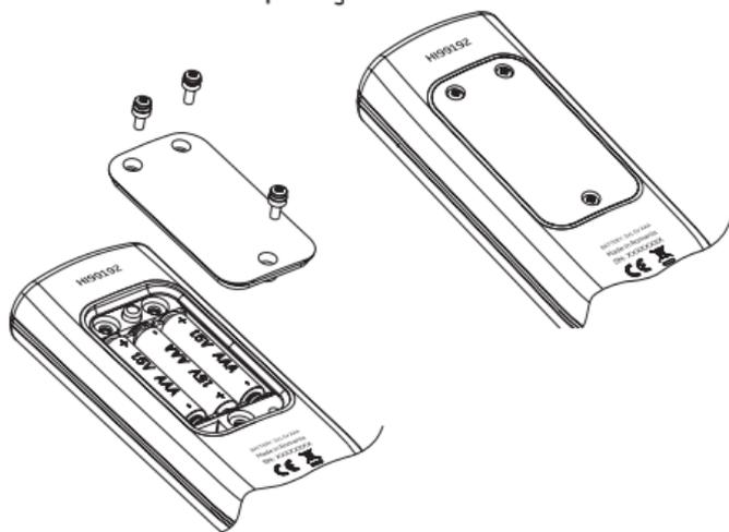
Substitua as três pilhas alcalina de 1.5V AAA que se encontram no compartimento, observando a polaridade correta.
