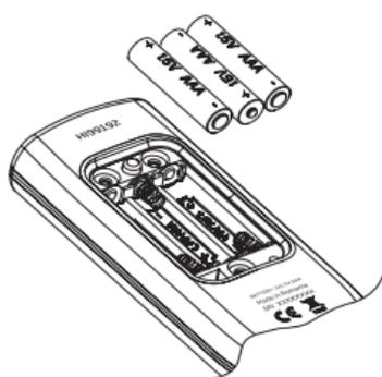
Volte a colocar a tampa do tampa e certifique-se de que a tampa ficou corretamente encaixada.
