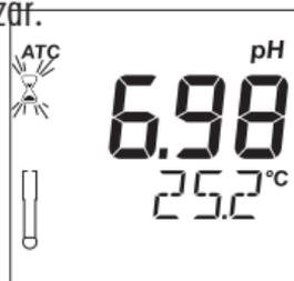
O valor de pH compensado automaticamente pela temperatura é indicado na área principal do LCD, enquanto que na área secundária é indicada a temperatura da amostra. Se as medições são efetuadas sucessivamente em diferentes amostras, recomenda-se enxaguar bem a extremidade da sonda em água destilada ou desionizada, de modo a prevenir a contaminação cruzada.
