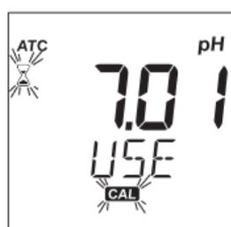
padrão pH 7,01 (pH 6,86 para NIST). O medidor entrará em modo de calibração, indicando "pH 7.01 USE" **CAL** e ⌚ a intermitente (ou "pH 6.86 USE" para NIST).
