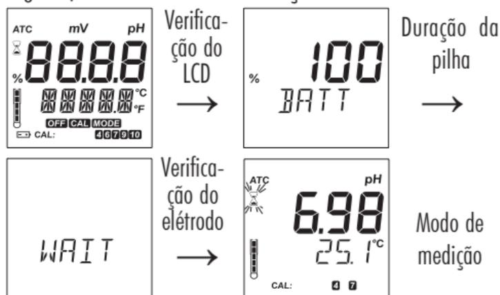
Nota: O medidor deteta a presença e o tipo de sonda na sua entrada.
