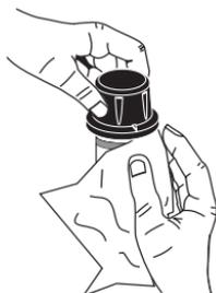
Agitar a cuvete pode gerar bolhas na amostra, provocando leituras mais elevadas. Para obter resultados precisos, remova tais bolhas agitando circularmente ou batendo cuidadosamente na cuvete.
