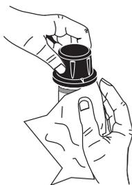
Agitar a cuvete pode gerar bolhas na amostra, provocando leituras mais elevadas. Para obter resultados precisos, remova tais bolhas agitando circularmente ou batendo cuidadosamente na cuvete.
