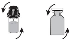
De modo a evitar o derrame do reagente e obter medições mais precisas, primeiro feche a cuvete com a tampa plástica HDPE fornecida
